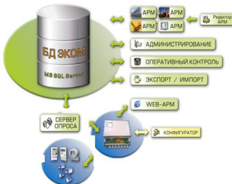
Рисунок 1.1 – Структура программного обеспечения ПТК ЭКОМ
