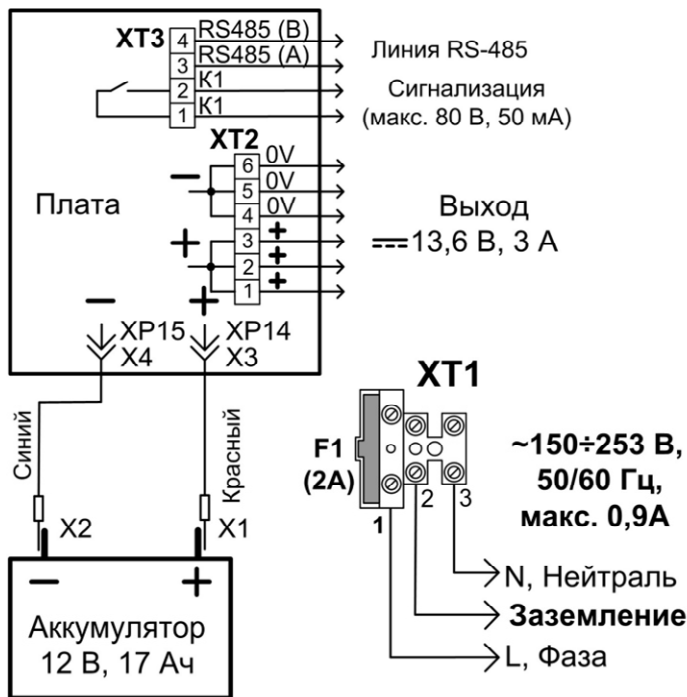
Схема подключений RIP-12 исп.51
