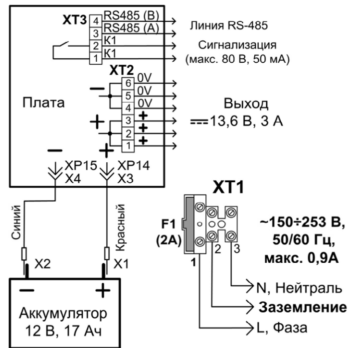
Схема подключений РИП-12 исп.51
